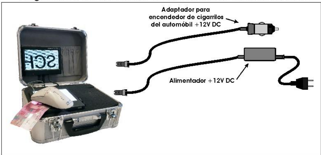
Diagrama de conexiones de alimentación del Portable TrueScan
